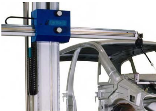
Feinantrieb manueller Ständermessmaschine
