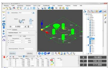
Das jeweils letzte **Messergebnis** wird direkt im Ergebnisfenster **mit grafischem Trendbalken** angezeigt. So sieht der Bediener auf einen Blick alle Abweichungen. Leichtes Erstellen von Ausrichtungen über die **3-2-1-Ausrichtung** oder die **Geometrische Ausrichtung** jeweils mit grafischer Vorschau. Die Ausrichtungen können beliebig gedreht und verschoben werden.
