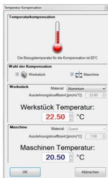
Die Temperaturkompensation kann **automatisch** oder **manuell** erfolgen. Bei der automatischen Kompensation werden die **Temperaturfühler** von ThomControl ausgelesen. Der Bediener wählt nur noch das passende Werkstückmaterial.
