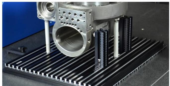
Alle Spannplatten haben T-Nuten und eingravierte Strichmarkierungen im Abstand von 25 mm. Sie dienen zur Orientierungshilfe beim Aufbau von reproduzierbaren Vorrichtungen.
